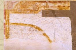
Meridiana a ore "babiloniche" tracciata su un'incisione a Castellagnone di Pavesi (TV). Questo sistema orario divideva il giorno in 24 ore uguali, e lo faceva iniziare e finire al sorgere del Sole. Dalla lettura della meridiana si possono sapere da quante ore è sorto il Sole.
