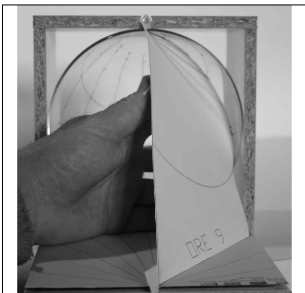
Figura 8- A causa della non perfetta rigidità del materiale aiuta parecchio predisporre un cartoncino adatto per il posizionamento sulla linea oraria dell'ora astronomica disegnata su di un piano orizzontale passante per il punto della sfera opposto al punto proiettante. Vedi disegno di Fig. 6.
