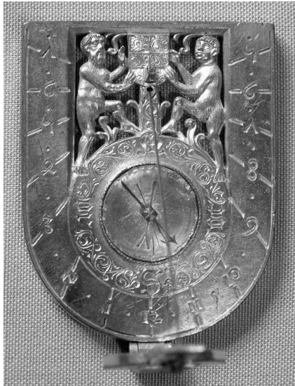
Lato con le indicazioni delle ore, bussola con l'indicazione della deviazione magnetica
