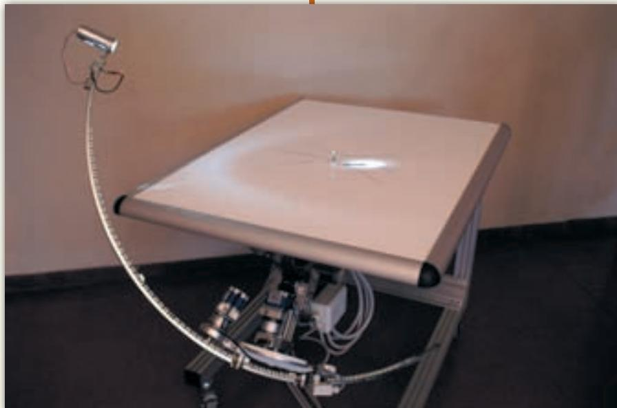
Fig. 5 Foto del simulatore di ombre orizzontali. I movimenti del faro/Sole sono controllati da una centralina computerizzata che aziona dei motori passo passo. Il piano è costituito da un vetro bianco sul quale si possono segnare, punti, rette e curve al fine di disegnare una meridiana orizzontale.
