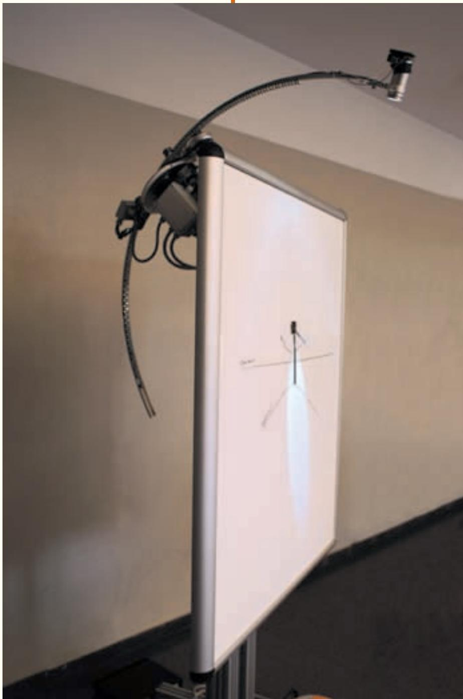
Fig.17 Il simulatore è formato da una parete che può ruotare per 30° Est e 30° Ovest rispetto al Sud. Lo gnomone invece è fisso, indirizzato alla stella Polare. La macchina evidenzia che nella costruzione delle meridiane verticali si deve calcolare la posizione relativa dello stilo rispetto al muro, in funzione della sua declinazione rispetto al Sud.
